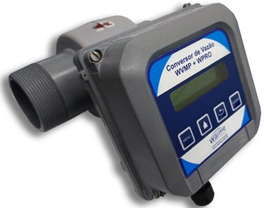
Disponível em duas versões: Versão Pro, aceita alimentação entre 18 a 36 VCC, tem saídas de 4-20 mA. e frequência ou pulso além da comunicação serial com protocolo Modbus. Versão Pro é alimentado por baterias de lítio com vida útil de até seis anos, tem saída de frequência ou pulso e comunicação serial com protocolo Modbus.
