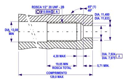
\* Todas as dimensões em milimetros (mm) / All dimensions are in milimeters (mm) (1) Superfície lisa para assento de vedação.
