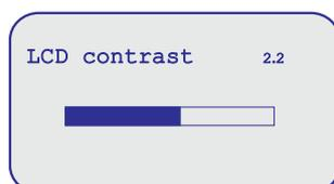
Pressionando ▲ pode aumentar o contraste ou diminuir com ➔ , confirme com **OK** para armazenar.
