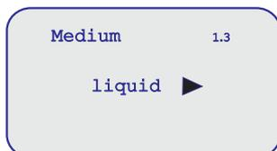
Pressione **OK**, em seguida mova as setas pressionando ➔ para alterar entre líquido ou sólido. Pressione **OK** para confirmar e armazenar e entrar no submenu fast level change.
