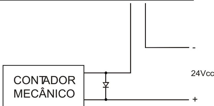
Utilizando fonte de alimentação para a saída de pulsos externa você ira manter a característica de isolamento da saída de pulsos (tensão de isolamento 1500 VCC), mas caso não necessite desta característica poderá utilizar a própria alimentação do equipamento borne (12 e 13).
