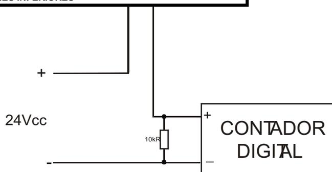
Utilizando fonte de alimentação para a saída de pulsos externa você ira manter a característica de isolamento da saída de pulsos (tensão de isolamento 1500 VCC), mas caso não necessite desta característica poderá utilizar a própria alimentação do equipamento borne (4 e 5).
