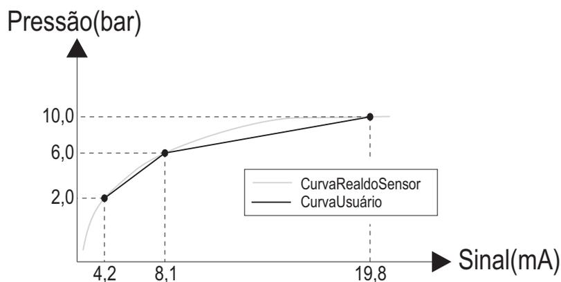
Dos pontos levantados, configura-se o indicador para obter a Curva do Usuário.
