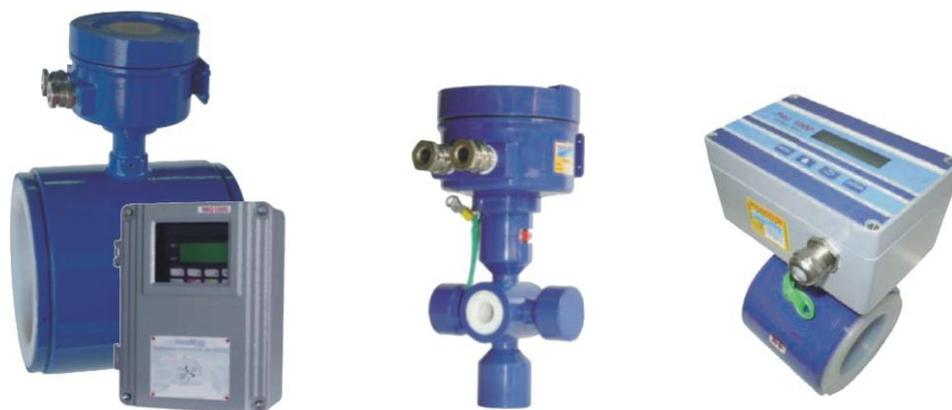
Os medidores de vazão da série **WVMW** são basicamente os mesmos da série **WVMF**, porém com conexão tipo wafer (sem flange). Estão disponíveis nos diâmetros nominais a partir de 2,5 mm até 250 mm (1/10" a 10").
